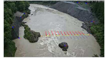
Analysis of flow velocity on Sediment Replenishment site with remote camera images 遠隔カメラ画像を用いた土砂還元（置き土）サイトの流速分布分析
